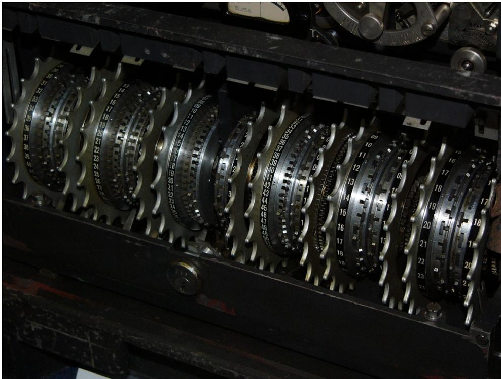
*Les rotors mécaniques de la machine de chiffrement de Lorenz considérée comme véritablement indéchiffrable pendant la Seconde Guerre mondiale. Les efforts britanniques pour percer le cryptage ont permis aux officiers d'accéder aux communications allemandes de haut niveau.*
