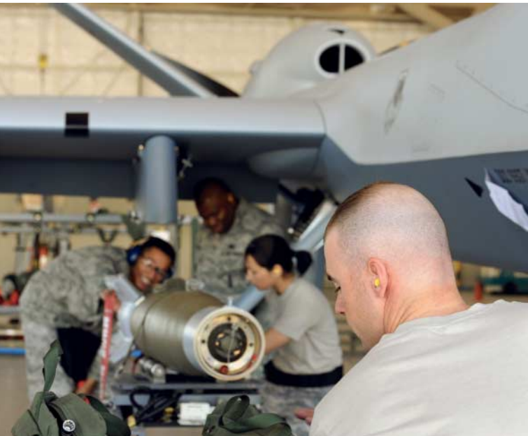
Klarmachen für den Einsatz: Amerikanische Soldaten bewaffnen eine Drohne vom Typ MQ-9 Reaper mit GBU-49-Präzisionsbomben. Sie werden von Laserstrahlen und GPS gelenkt.
